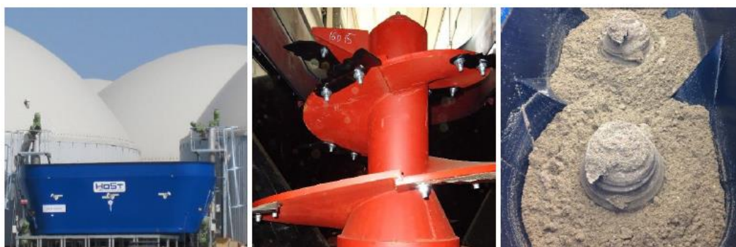
Rysunek 9 System dozowania sypkich substratów
